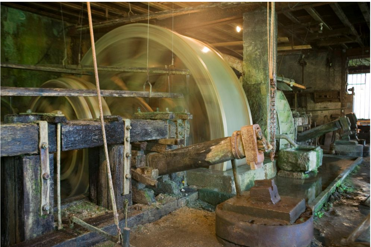
Photo 6 : Taillanderie de Nans-sous-Sainte-Anne, Doubs : martinets de forge en fonctionnement.©Musées des techniques et cultures comtoises/Cl. J-B. Mérimot.
