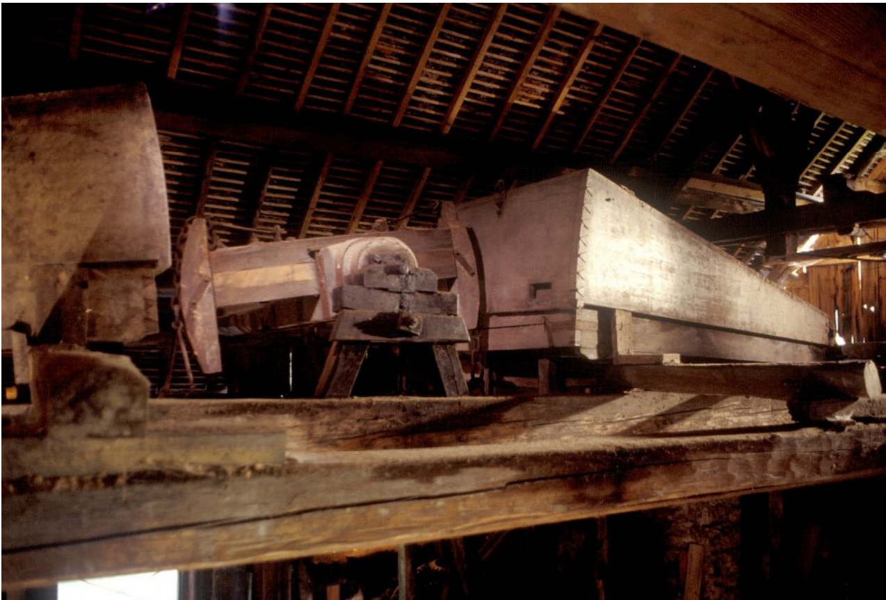
Photo 7 : Taillanderie de Nans-sous-Sainte-Anne, Doubs : soufflets de forge. ©Musées des techniques et cultures comtoises/Cl. F. Royet.
